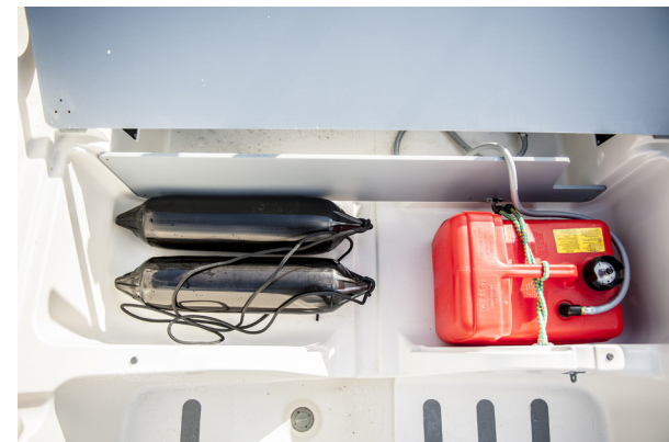
▲ Här ryms fendrar och tanken. Utrymmet är låsbart men blött under gång. Motorbrunn saknas och de vågor som slår över aktern rinner rakt in.
